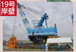
グラブ浚渫船兼起重機船 27金剛
