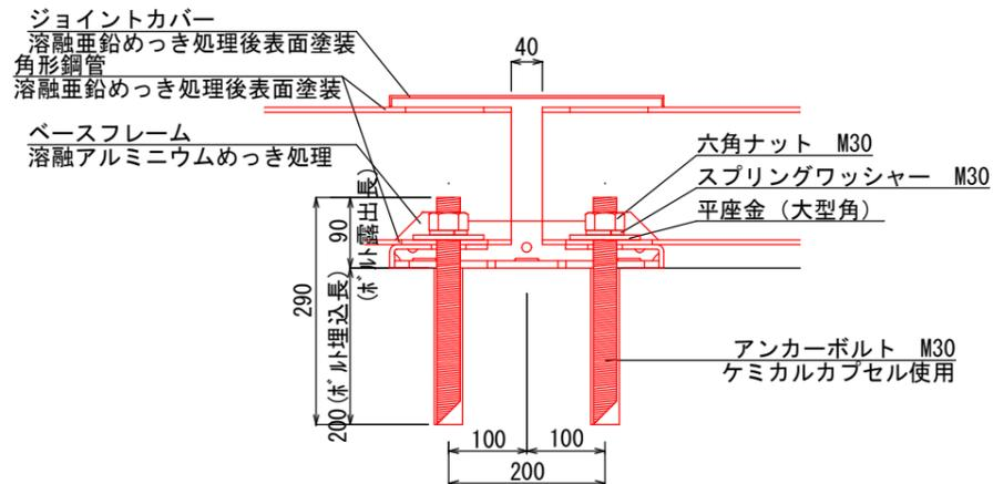
車止設置断面図200用
