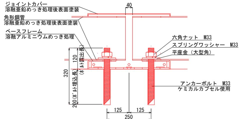
車止設置断面図300用
