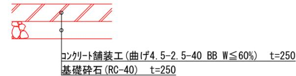
※コンクリート舗装工について、10mに1箇所、成形目地(瀝青質 t=10)を設置すること。
