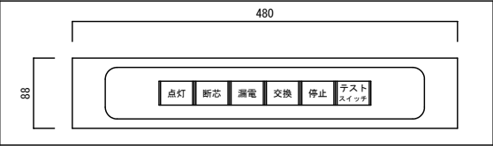
更新 航空障害灯遠方操作パネル
