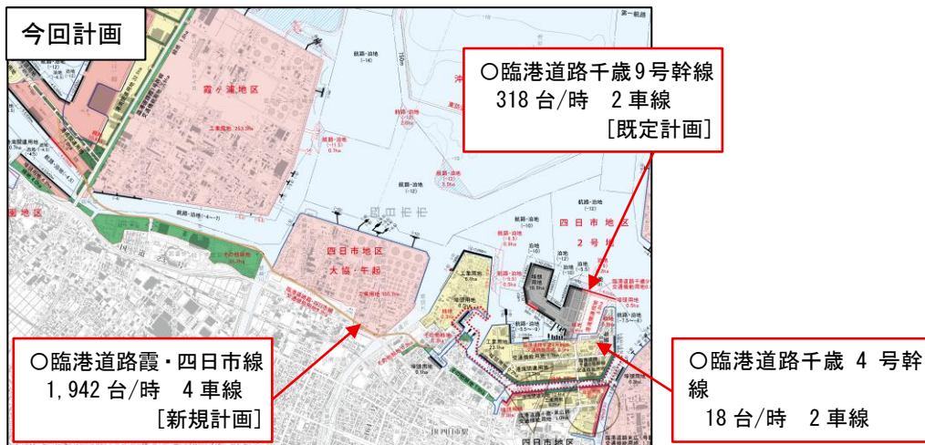
図Ⅲ-9-2(2) 今回計画する臨港道路の位置図（霞ヶ浦・四日市地区）
